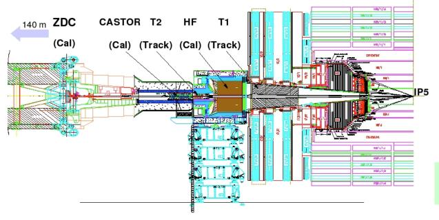
**T1** (CSC)  $3.1 \le |\eta| \le 4.7$  **HF**  $3 \le |\eta| \le 5$  **T2** (GEM):  $5.3 \le |\eta| \le 6.6$ **Castor**  $5.3 \le |\eta| \le 6.6$
