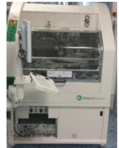
Multi-chip die bonder • \pm 10 \mu\text{m} • \sim 1000 dies/h
