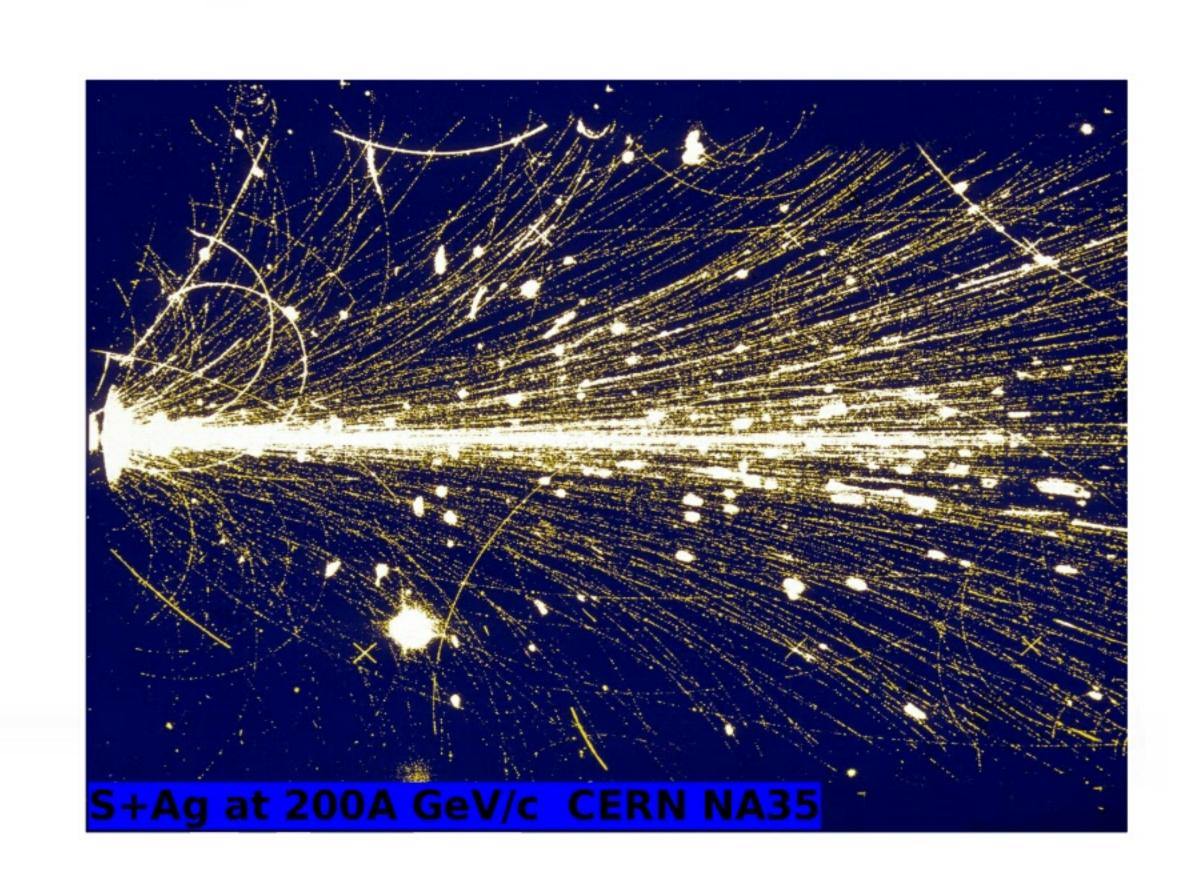
SHAG COLLISION AT 200A GeV/C SEEN BY THE NA35 STREMER CHAMBER
