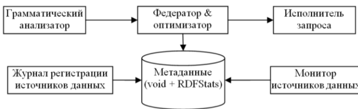
Рис. 6 Структура посредника системы интеграции SemWIQ
