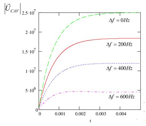
$$\hat{\vec{U}}_{CAV} \approx \frac{R_{SL} \left[ \vec{I}_G - \vec{I}_B \right]}{1 + iQ_L 2 \frac{\Delta \omega}{\omega_{CAV}}}$$
