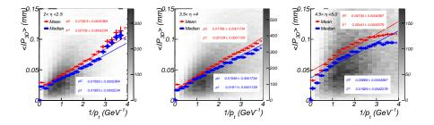
•  $\eta \in [2; 2.5]: < |IP_{3D}| > 19(\mu m) + 21(\mu m)/pt(GeV),$ •  $\eta \in [3.5; 4]: < |IP_{3D}| > 17(\mu m) + 19(\mu m)/pt(GeV),$ •  $\eta \in [4.5; 5]: < |IP_{3D}| > 47(\mu m) + 20(\mu m)/pt(GeV)$
