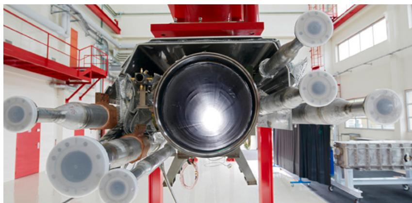
Coupleurs de puissance à Orsay et trains de cavités supraconductrices à Saclay pour l'accélérateur du futur centre de recherche XFEL à Hambourg. Le CNRS et le CEA y jouent un rôle de premier plan.
