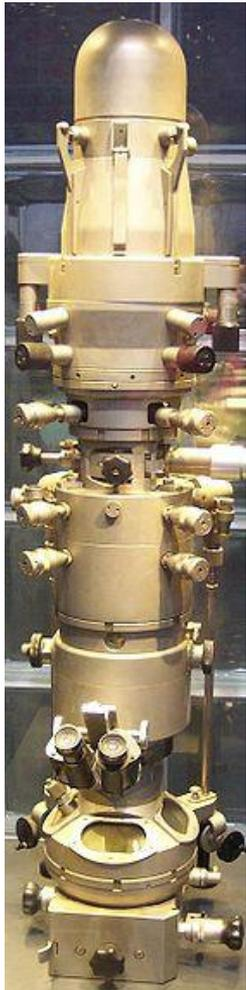
Elektronenmikroskop: 0.1 nm (Millionstel Millimeter)
