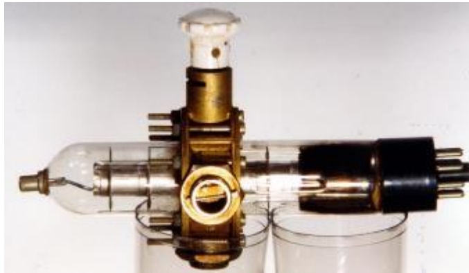
A WW2 3 GHz klystron
