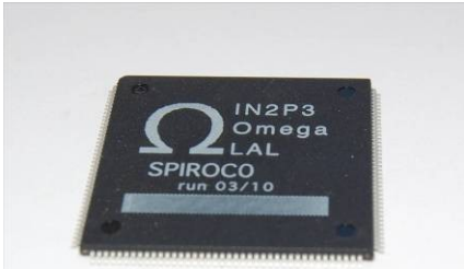
TQFP: height=1.4 mm
