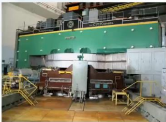
Phasotron, protons 170 MeV
