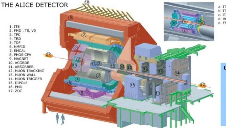
a. ITS SPD Pixel b. ITS SDD Drift c. ITS SSD Strip d. V0 and T0 e. FMD
