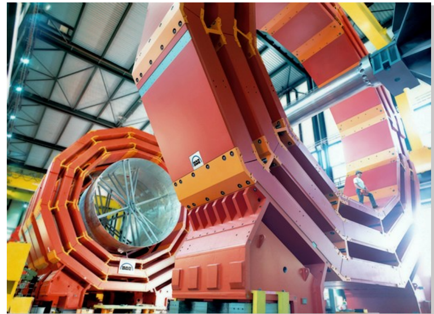
Eisenjoche des CMS Magneten hergestellt von MAN Deggendorfer Werft (Präzisionsfertigung von 10'000 t Eisen)
