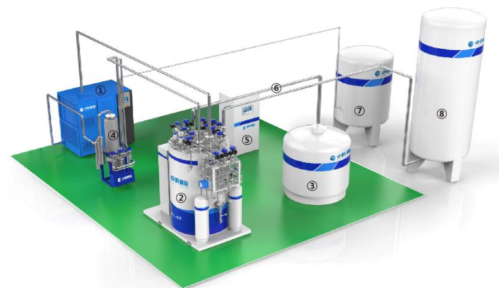
① 氦压缩机 ② 4.5K冷箱 ③ 液氦杜瓦 ④ 油分离器 ⑤ 控制柜 ⑥ 同轴输液管 ⑦ 氦气缓冲罐 ⑧ 液氦储罐
