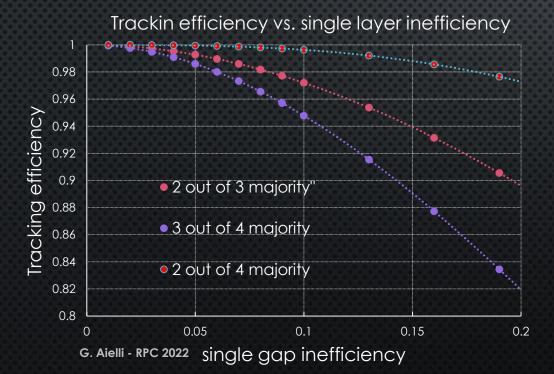
• THE BIS78 CHAMBER TRIPLET ALLOWS TO LOCALIZE A TRACK ELEMENT WITH THE 2 OUT OF 3 MAJORITY
