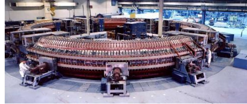
The BNL Cosmotron, 3.3 GeV, 23 m diameter
