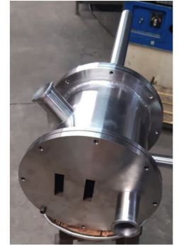
Bancada com câmara de vácuo para Skipper CCDs @ UFRJ
