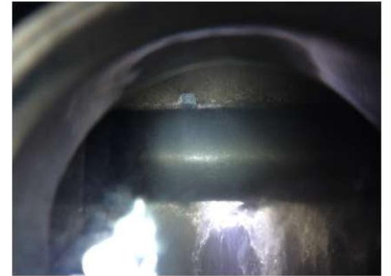
冷却水が噴射されている時にホーンのビューポートから内部の様子を観察した写真。
