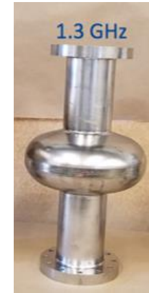
Mono-cellule elliptique 1300 MHz
