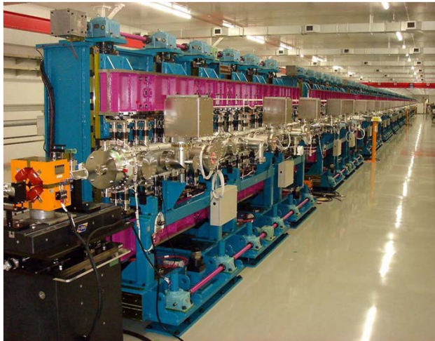
SACLA -XFEL(SPring-8) IVU L=18 \times 5\text{m} , \lambda_U=18\text{mm}
