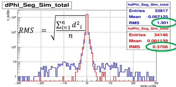
Разница в точной координате между мюонным трек-сегментом и симулированной траекторией мюона
