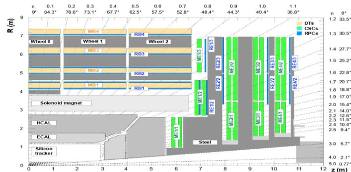
Расположение КСК в экспериментальной установке CMS
