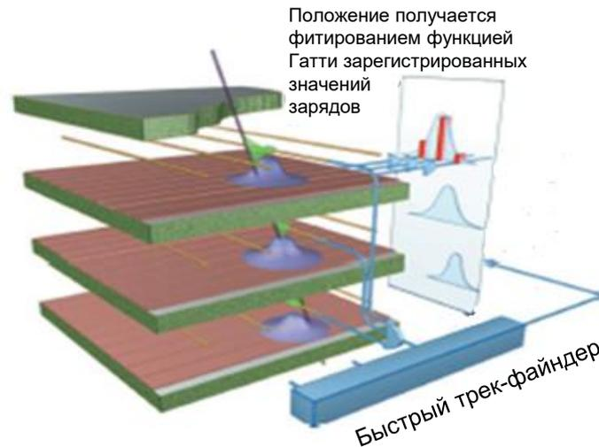
Положение получается фитированием функций Гатти зарегистрированных значений зарядов
