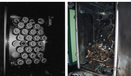
CTF3 Modulator (before-after fire)
