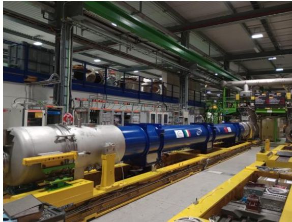
D2 cold mass on the test bench in SM18 (S. Farinon, B. Caiffi, A. Bersani, A. Foussat, et al)
