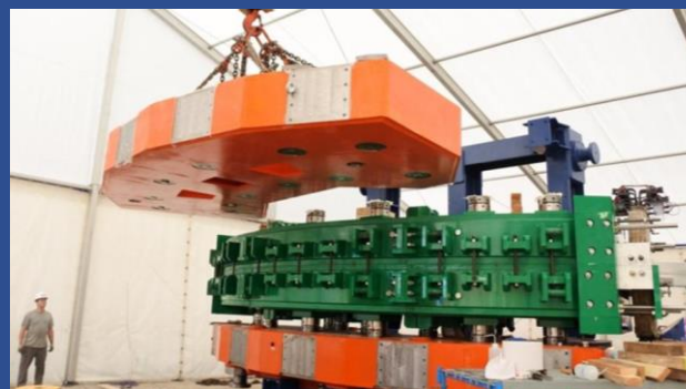
90° Dipole - MedAustron Protontherapy center (Austria)
