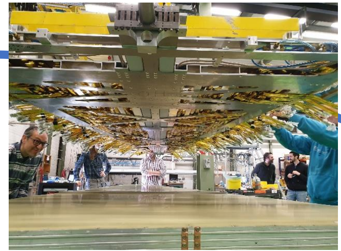
54 km of twinax cables kaptonised
