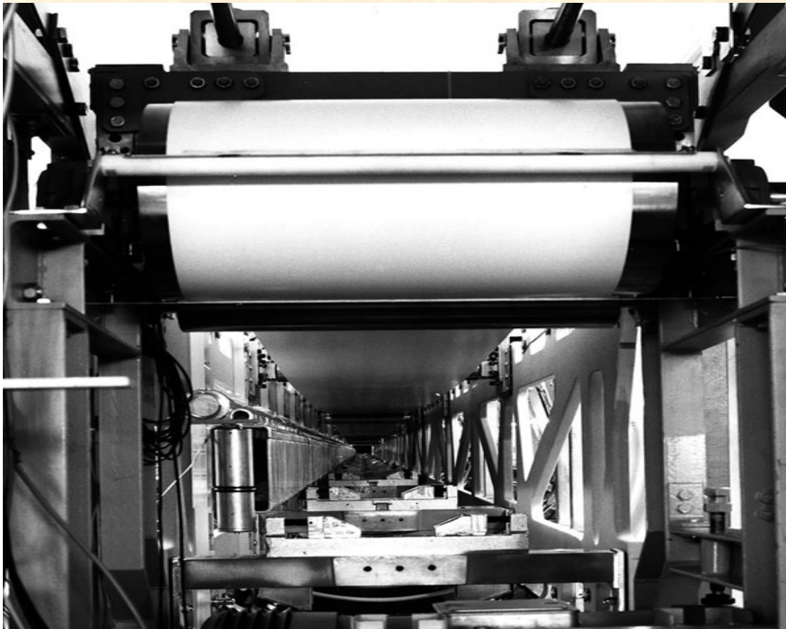
mechanischer Transport der Ladung mittels Glasfaserband
