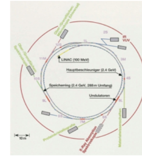
SLS mit LINAC 100 MeV, Booster 2.4 GeV, Speicherring und Experimentierstationen
