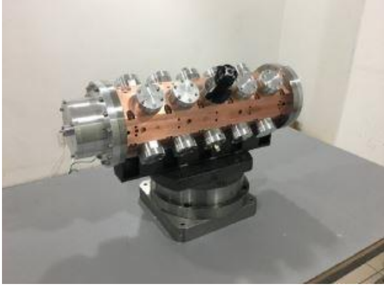
Şekil 7: Uç Kapakların Montajı Sonrası RFQ Test Modülünün Görünümü
