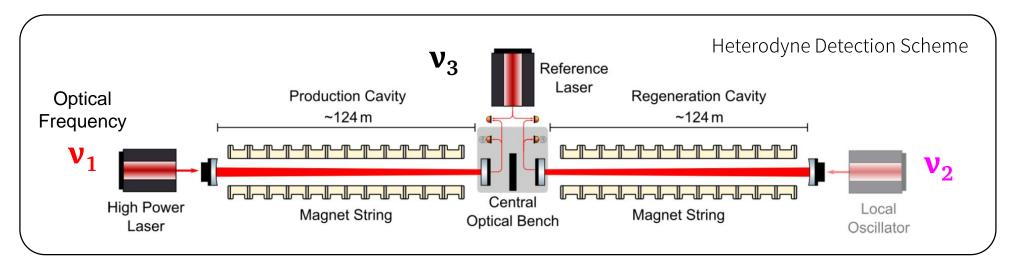
Heterodyne  $\rightarrow v_1 \neq v_2$
