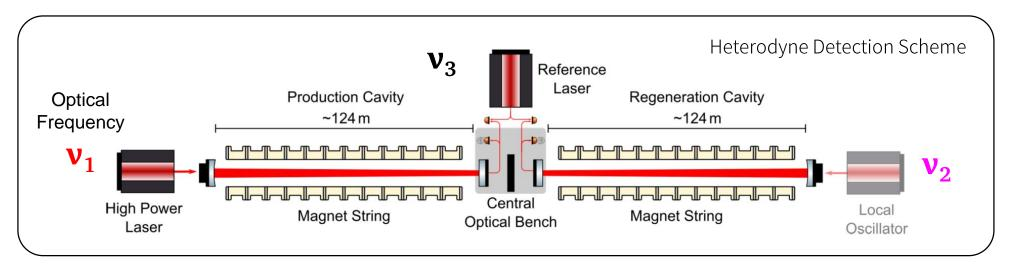
Heterodyne  $\rightarrow v_1 \neq v_2$
