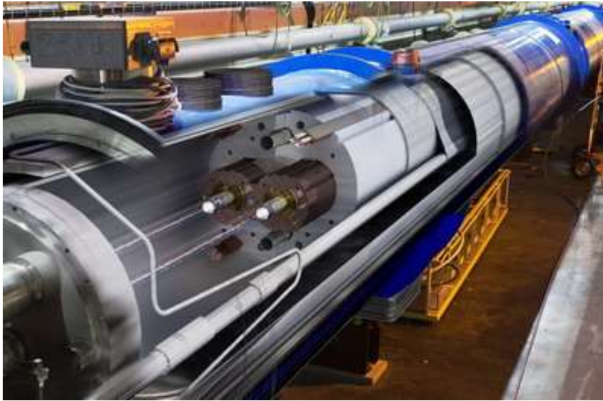
Dipól mágnes röntgen rajza
