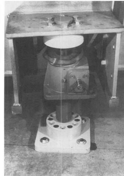
ALS 20-ton machine screw jack strut.
