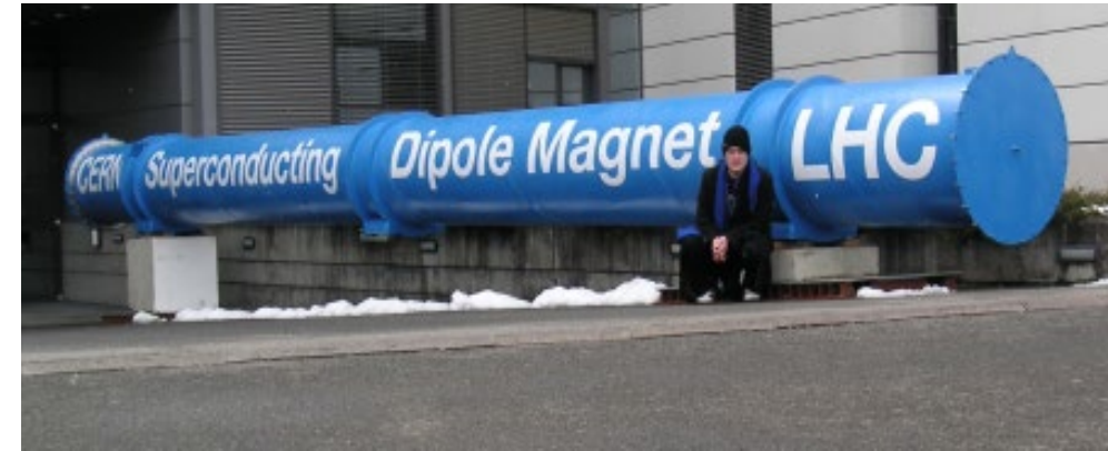
8.3 Tesla supermagnet – 15 m long
