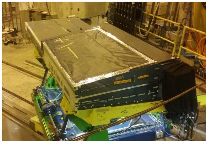
**Quelques modules du calorimètre hadronique d'ATLAS testés avec un faisceau de particules.**
