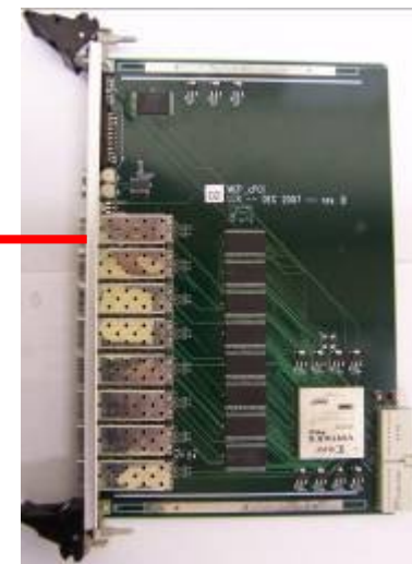
G. Varner: BLAB2 readout system for f-DIRC
