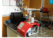
Espectroscopia de massa eletroquímica diferencial para teste de célula a combustível.
