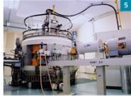
Cyclone 30 - Acelerador de Partículas Ciclotron de 30 MeV.
