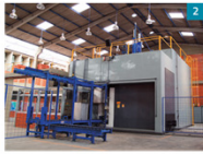
Irradiador Multipropósito de ^{60}\text{Co} de 37 PBq.
