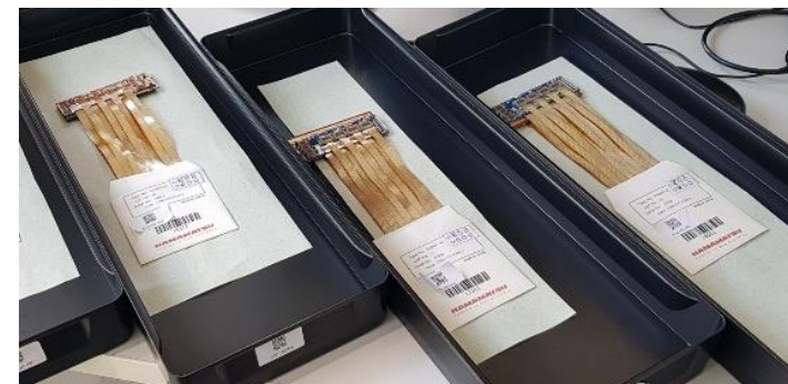
Pre-series STS module production for E16 (J-PARC) exp.
