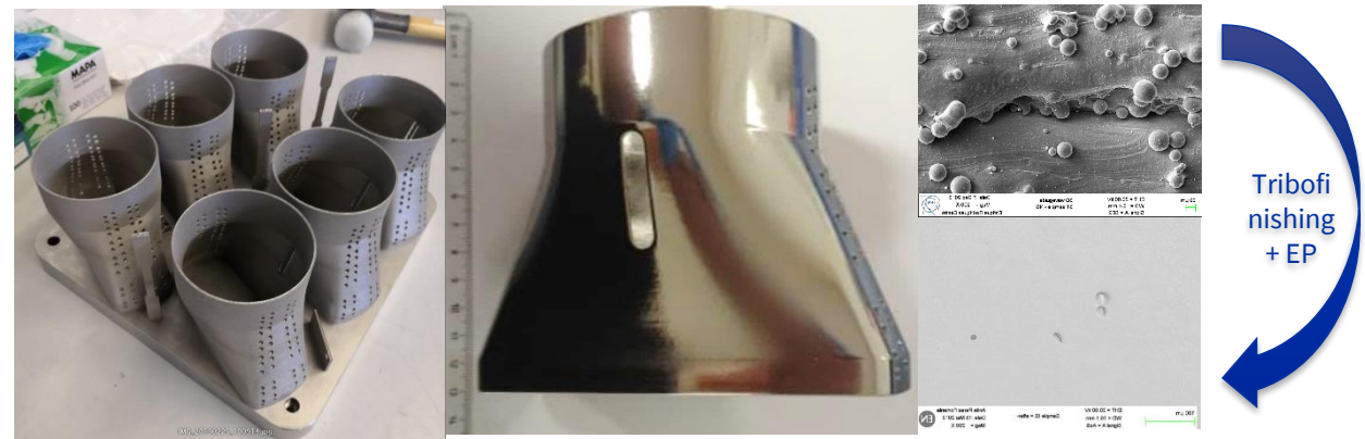
SPS pumping port shields Finition des pièces compatible UHV
