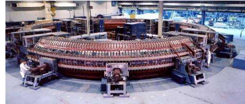
The BNL Cosmotron, 3.3 GeV, 23 m diameter
