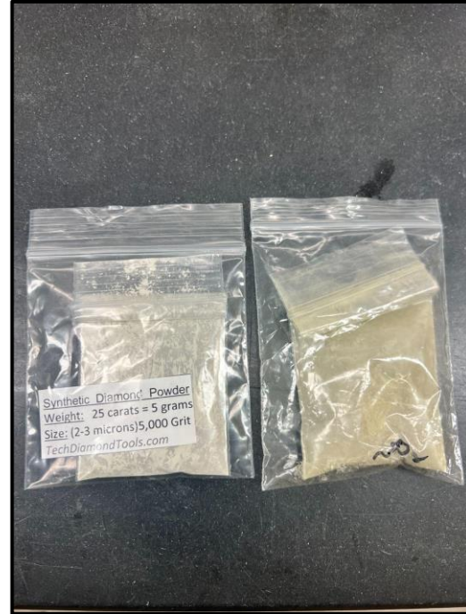
Synthetic Diamond Powder Left 2.4 um right is 20 um
