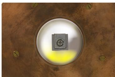
Figure 2: Messsonde zentriert ( $y = 0 \text{ mm}$ ) [1]
