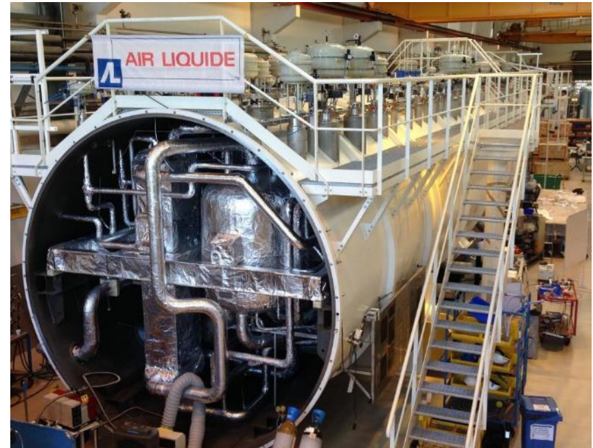
« 25 kW @4.5 K » ITER cold box
