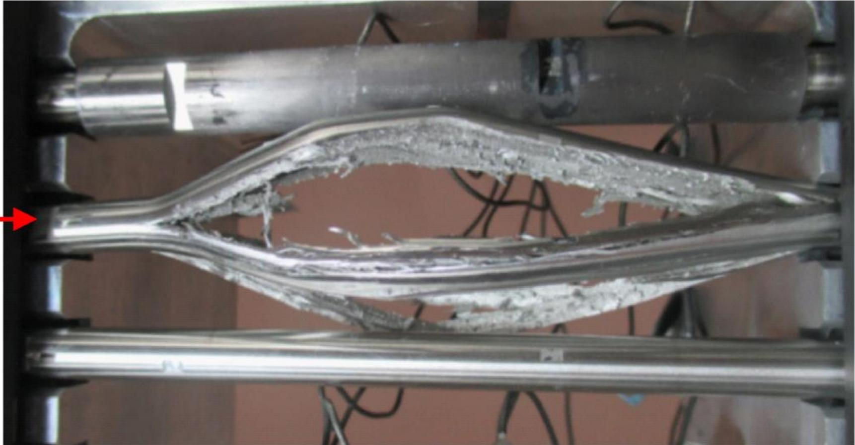
Cible test après un impact d'un paquet de  $1,7 \times 10^{12}$  protons à 500 GeV...
