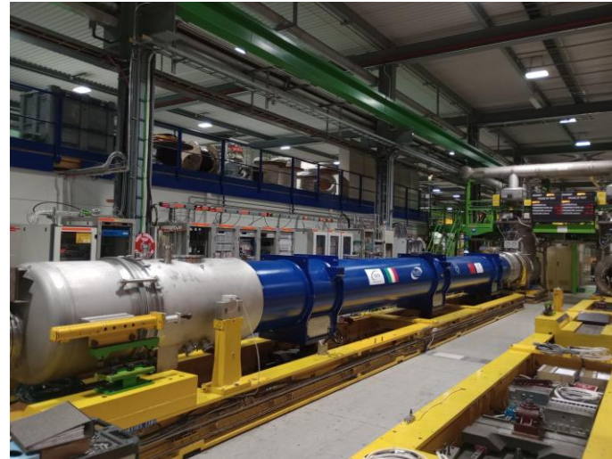
D2 cold mass on the test bench in SM18 (S. Farinon, B. Caiffi, A. Bersani, A. Foussat, et al)
