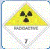
Σήμανση ειδικών δοχείων μεταφοράς ραδιενεργών πηγών
