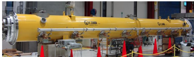
1.3 GHz ILC Type Module
