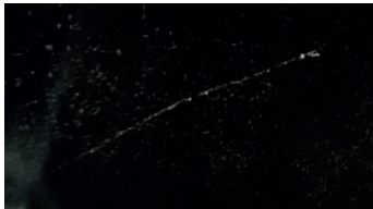
Abb. 17: Energiereiches Elektron gibt alle Energie ab, erzeugt sekundäres Elektron
