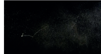
Abb. 16: Energiearmes Elektron wird gestreut, gibt alle Energie ab und erzeugt sekundäres Elektron
