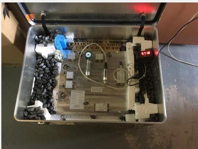
Prueba de presión del detector  $^3\text{He}$  Denex (2D-Position-Sensitive Neutron Detector) que será implementado para el difractor ANDES y servirá de referencia para el desarrollo de detectores alternativos.
