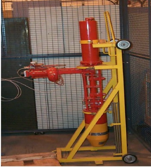
S-Band 35 MW Klystron (TH2128)
