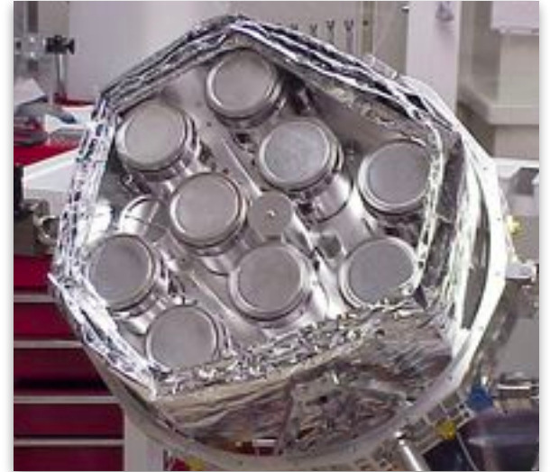
RHESSI uzay teleskobunda 75K ve 4kV altında kullanılan 9 hipersaf Ge dedektör (7.1cm çap x 8.5cm uzunluk).
