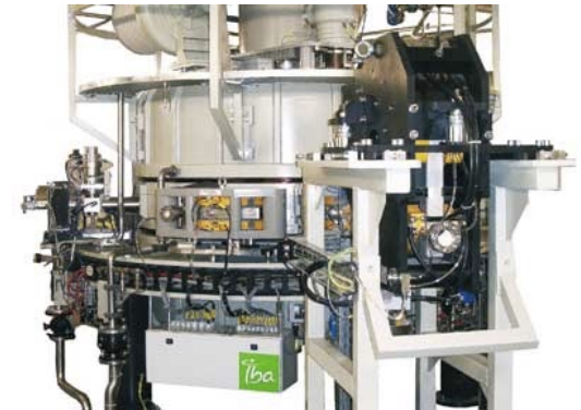
IBA rhodotron – e-ışın sterilizasyonu için kullanılan ticari bir hızlandırıcı
